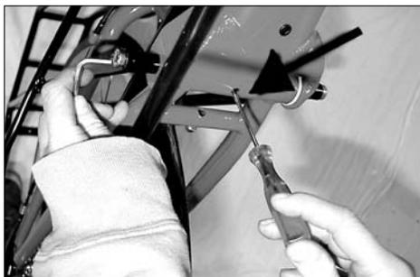
Auf der Unterseite der Hinterradschwinge befindet sich eine Bohrung. Mit einem dünnen Schraubendreher oder einem Metallstift kann die Achse gegen Verdrehen gesichert werden.
