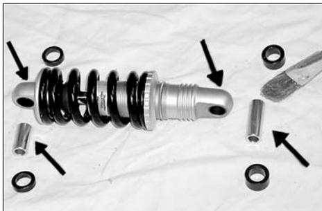
Die Lagerbuchsen des Federelementes müssen mit Fett geschmiert werden.
