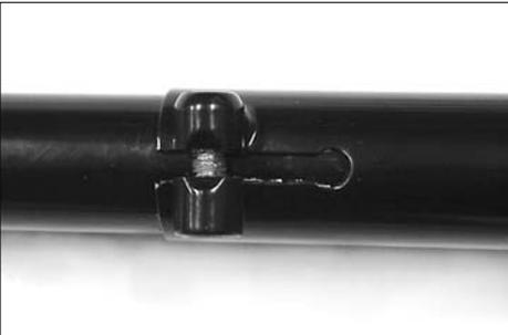
Beim Blick in den Klemmschlitz darf das Rohrende der oberen Vorbauhälfte nicht sichtbar sein. Achten Sie auf die korrekte Position der Kunststoffeinlage.
