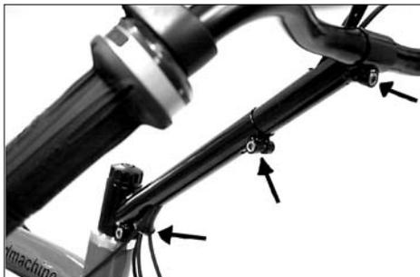
Am Lenkervorbau befinden sich drei Klemmschrauben zur Längeneinstellung.
