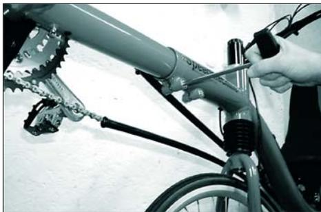
Lösen der Klemmschrauben zum Verstellen des Tretlagerauslegers.
