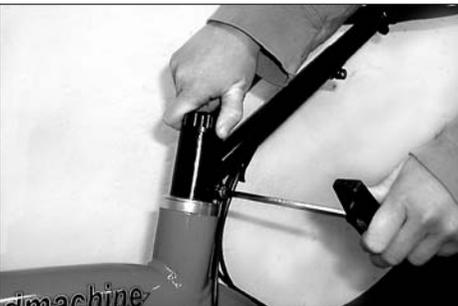
Dämpfungseinstellung durch Drehen der Abdeckkappe.
